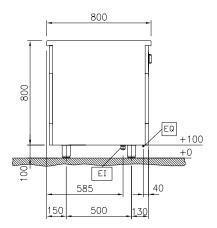
Electrical inlet (power) EQ Equipotential screw
